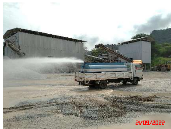
รูปที่ 10 การฉีดพรมน้ำบริเวณเส้นทางขนส่งแร่
